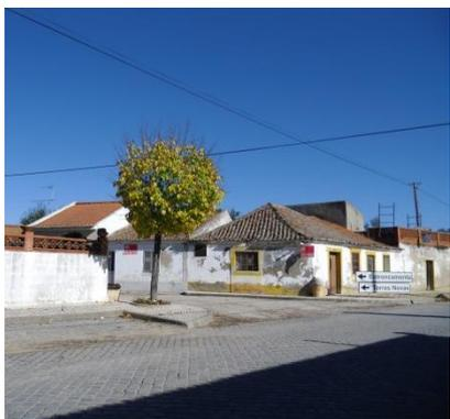
**Figura 17** - Rua D. João IV – Faixa de rodagem revestida a cubos de granito e passeios em calçada
